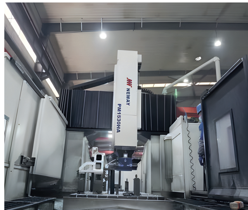
3-метровый порталый обрабатывающий центр с ЧПУ производства NEWAY
