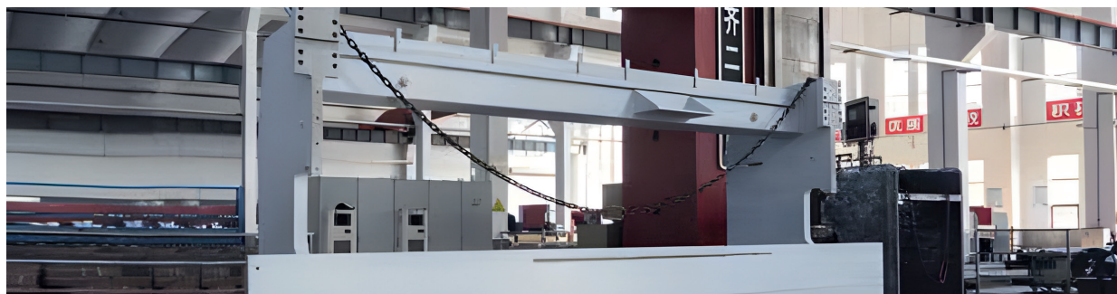
6-метровый напольный фрезерно-расточной станок с ЧПУ производства Giqihar No. 2 Machine Tool Co., Ltd.
